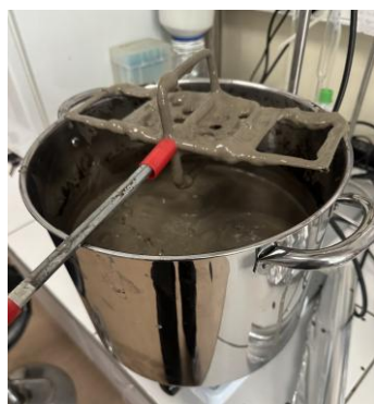
Kartupeļu šūnsulas retentāta termiskā apstrāde (karsēšana) ~60 °C temperatūrā ar nepārtrauktu maisīšanu.
