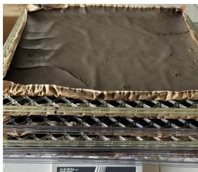
Retentāta masas žāvēšana plānā slānī kontrolētā temperatūrā, nodrošinot vienmērīgu mitruma samazināšanos.
